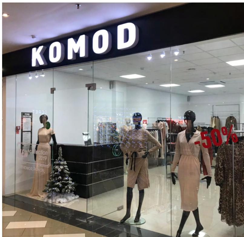
Основание вывески – композитный материал, толщина – 50мм, (двойная отбортовка (сгиб) вывески). Толщина световых объемных элементов не должна превышать – 60мм от основания вывески. Общая толщина готовой рекламной конструкции не должна превышать – 110мм.
